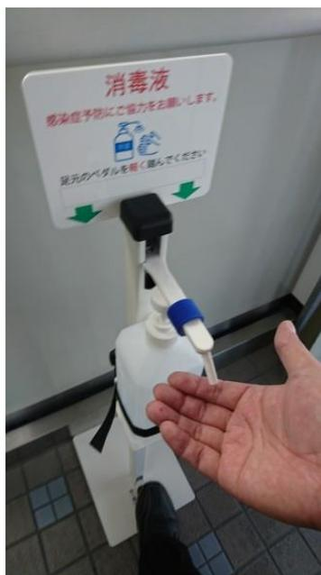
ペダルを踏むだけで、ボトルをプッシュして消毒液を噴霧できます。
